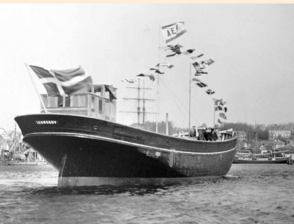
J. Ring-Andersen kombiniert das Rundheck eines Klipperschoners mit dem konvexen Vorsteven der Jachtschoner. Ein besonders markanter Schnitt dieses schönen Schiffstyps lief ab 1939, ein Motorsegler von etwa 100 BRT und als Dreimastschoner getakelt, in einer Serie von sechs Schiffen vom Stapel.
