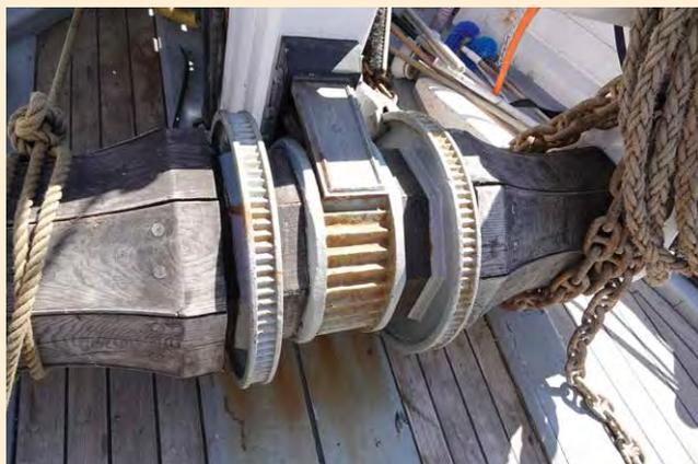
Die Trommel mit dem mittigen Zahnrad entspricht der Bauart in Svendborg.
