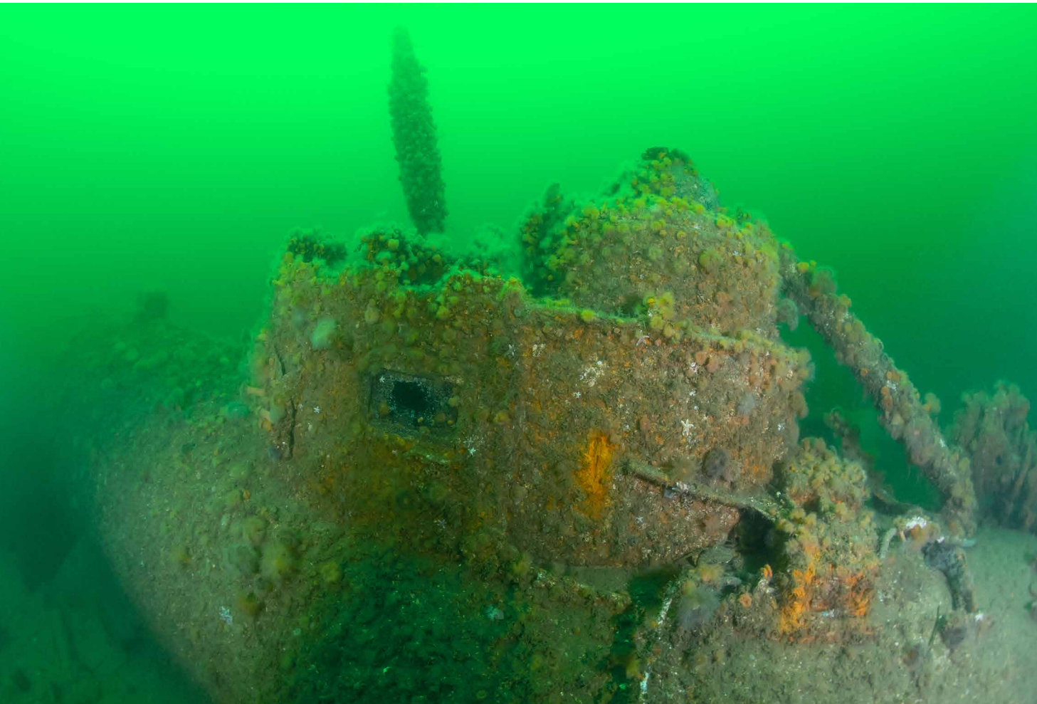
Das Wrack steht aufrecht auf dem Grund in rund 14 Meter Tiefe. Die ehemals durchsichtige Kuppel auf dem Turm ist fast unbeschädigt. Das Periskop ist teilweise abgerissen.
